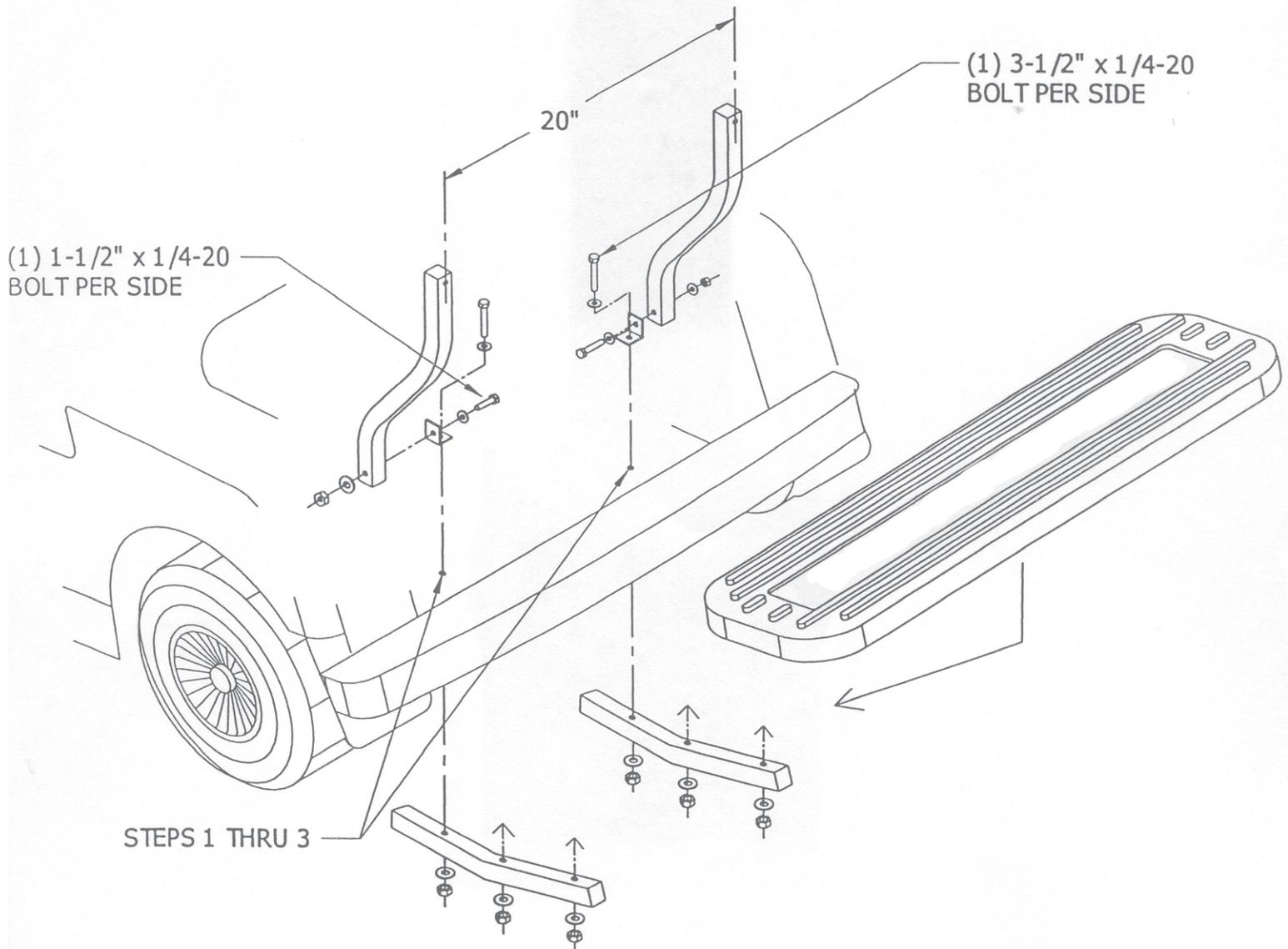
FOLLOW SEQUENCE BELOW; *FINGER TIGHTEN ONLY UNTIL UNIT IS FULLY ASSEMBLED, THEN TIGHTEN COMPLETELY.*
